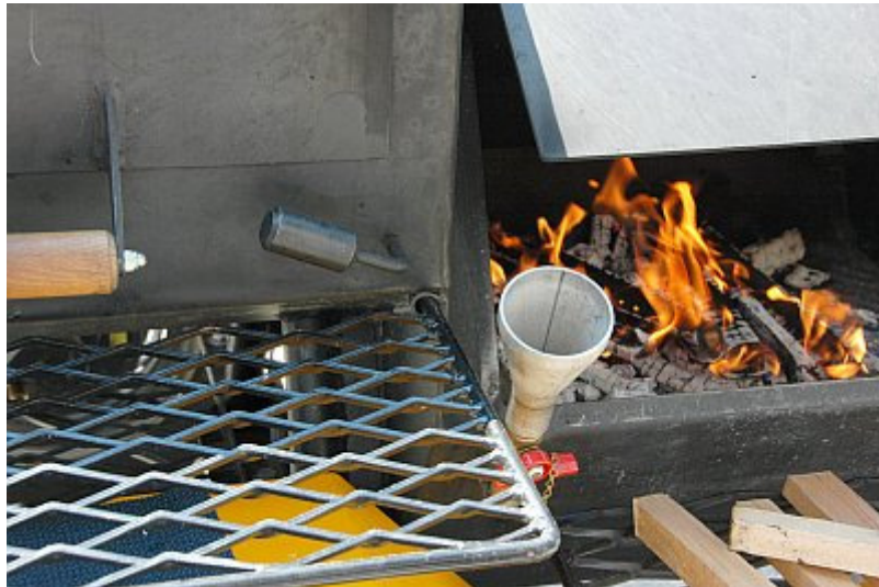
Eine Spezialität bei diesem Smoker ist ein Trichter an der Feuerbox, wo man Wasser hineingeben kann, um im Garraum feuchte Luft zu erzeugen.
